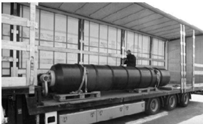
Ziehkopf d 800 SDR7,4 | mit längsseitigen Langlöchern zum Spülen mit Betonit
